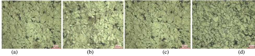
Fig. 4. (a) Microstructure of pure iron at 100 $\mu\text{m}$ ; (b) 0.25wt. % CNT at 100 $\mu\text{m}$ ; (c)Microstructure of 0.50wt. % CNT at 100 $\mu\text{m}$ ; (d) 0.75wt. % CNT at 100 $\mu\text{m}$ .
