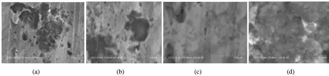
Fig. 5. (a) Pure Iron (b) 0.25 wt. %CNT; (c) 0.50 wt. %CNT; (d) 0.75 wt. % CNT.
