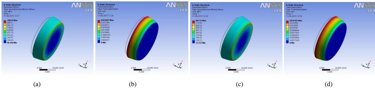
Fig. 7. (a) 0.50 wt.% CNT - von-mises stress; (b) 0.50 wt.% CNT – Total Deformation; (c) 0.75 wt.% CNT - von-mises stress; (d) 0.75 wt.% CNT – Total Deformation.
